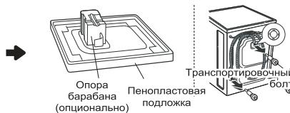
Снимите транспортировочные болты и опоры.
