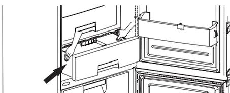
**КАК СНЯТЬ КРЫШКУ ВЫДВИЖНОГО ЯЩИКА**
