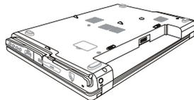
2. Осторожно задвиньте батарею на место до ее фиксации в батарейном отсеке.
