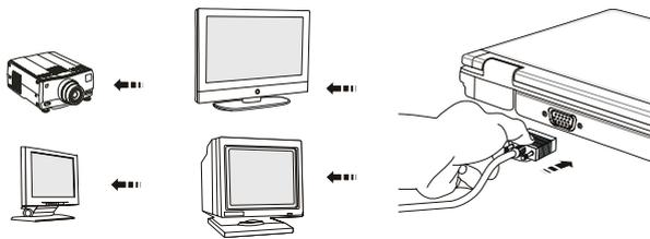
Для подключения внешнего дисплея выключите ноутбук и внешний дисплей, а затем подключите дисплей к ноутбуку.
