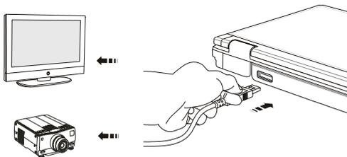
15-контактный порт D-Sub VGA позволяет подключить внешний монитор или другое стандартное VGA-устройство (такое как проектор) для просмотра изображений с ноутбука.
