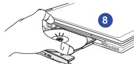
9. Задвиньте лоток назад в привод.
