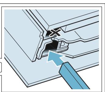
2. Полностью откройте дверцу прибора. Снова установите блокировочные рычаги (рис. 2).
