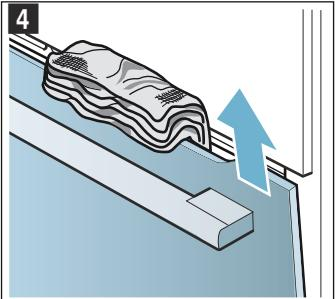
**Указание:** Очистите вставку из нержавеющей стали в защитной панели средством для чистки металлических изделий. Очистите оставшуюся часть защитной панели дверцы мягкой тряпкой с тёплым мыльным раствором.
