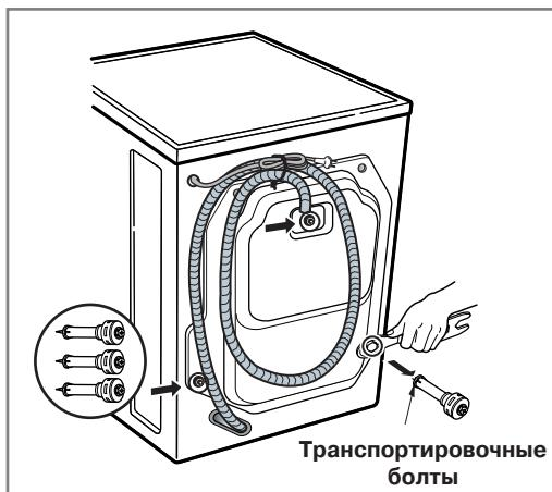
1. Отвинтите 3 болта при помощи гаечного ключа, который входит в комплект поставки машины.
