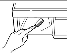
3. При помощи щетки очистите отсек для выдвижного ящика.
