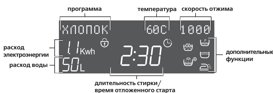
Рисунок 2 — Зоны индикации дисплея
