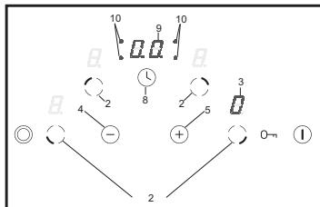
**! Terminarea duratei setate este semnalizată cu semnale de alarmă scurte și multiple. Pe indicatorul (3) corespunzător pentru ochiul respectiv se aprinde „0”, ochiul nu emană căldură și pe displayul ceasului (9) se aprinde „00”.**
