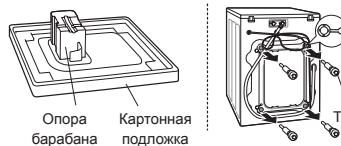
Снимите транспортировочные болты и опоры.
