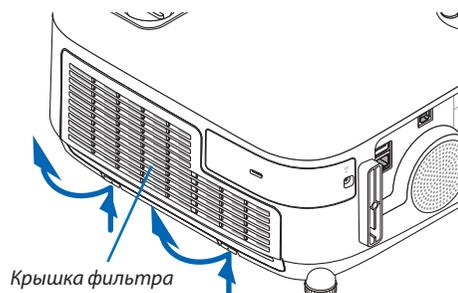
2. **Извлеките корпус фильтра, сдвинув крепление.**
