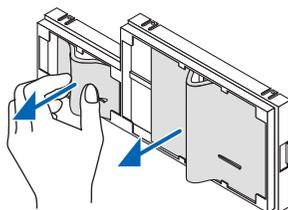
(2) Выдвиньте левый конец каждого фильтрующего элемента и выньте два ячеистых фильтрующих элемента грубой очистки (большой и маленький).
