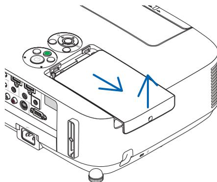
**2. Снимите корпус лампы.**
