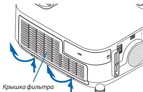
2. **Извлеките корпус фильтра, сдвинув крепление.**
