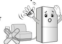
**Запрещается заменять сетевой шнур или менять его длину. Это может вызвать его повреждение и привести к короткому замыканию и стать причиной пожара.**
