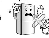
**Вилку следует вынимать из розетки при уборке, чистке или замене лампочки внутри холодильника.**
