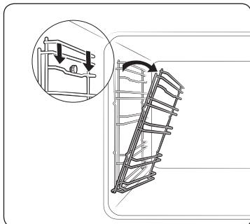
1. Нажмите на верхнюю часть левой направляющей и опустите ее вниз, наклонив под углом 45°.
