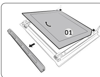
2. Снимите крышки, сдвинув их в направлении, указанном стрелкой.
