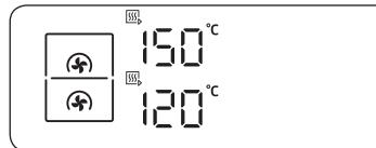
Духовой шкаф начинает предварительный прогрев, во время которого на дисплее отображается значок . Предварительный прогрев завершается, когда температура внутри духового шкафа достигает заданного значения. Предварительный прогрев духового шкафа рекомендуется выполнять во всех режимах приготовления, кроме отдельных случаев, указанных в руководстве по приготовлению.
