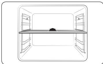
Установите разделитель на уровне 3, чтобы разделить внутреннее пространство духового шкафа на две камеры. Духовой шкаф автоматически определяет наличие разделителя и по умолчанию включает верхнюю камеру.
