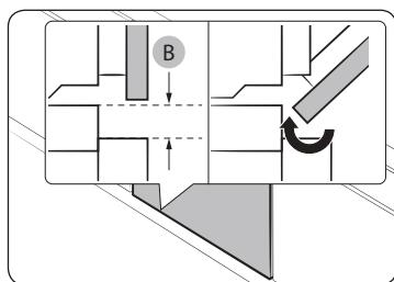
Также оставьте зазор **(B)** не менее 3 мм, чтобы дверца легко открывалась и закрывалась.
