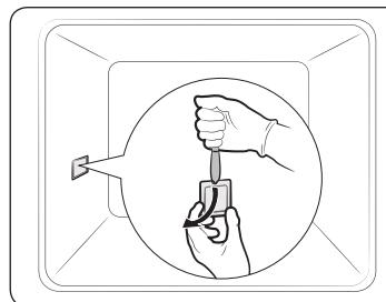
1. Возьмитесь за нижнюю часть плафона лампы, расположенной на боковой стенке камеры духового шкафа, и снимите его, помогая себе плоским заостренным предметом, например ножом.
