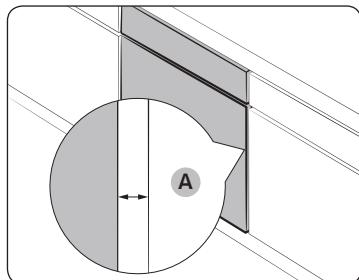
Оставьте зазор **(A)** не менее 5 мм между духовым шкафом и каждой из стенок отсека.
