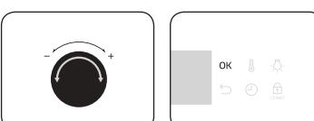
3. С помощью переключателя значений установите температуру, а затем нажмите **OK**.
