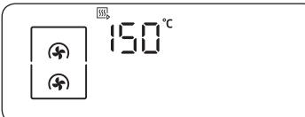
Духовой шкаф начинает предварительный прогрев, во время которого на дисплее отображается значок . Предварительный прогрев завершается, когда температура внутри духового шкафа достигает заданного значения. После завершения предварительного прогрева воспроизводится звуковой сигнал и индикатор перестает отображаться на дисплее. Предварительный прогрев духового шкафа рекомендуется выполнять во всех режимах приготовления, кроме отдельных случаев, указанных в руководстве по приготовлению.
