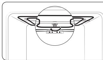
**1.** Опустите нагревательный элемент гриля. Для этого, удерживая нагревательный элемент гриля, отверните круглую гайку, вращая ее против часовой стрелки. Нагревательный элемент гриля не является съемной деталью. Не давите на нагревательный элемент гриля.
