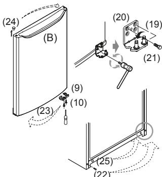
Открутите винт (10) на нижней части двери, фиксирующий упор (9) двери морозильного отделения, переместите упор (9) на противоположную сторону в
