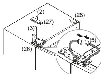
Установите дверь холодильного отделения путём совмещения отверстия в нижней части двери и оси средней петли (17). Затем установите верхнюю петлю (26), поместив ось в соответствующее верхнее отверстие двери холодильного отделения. Соедините разъемы кабеля (5) (только для моделей с дисплеем внешнего типа). Закрепите верхнюю петлю (26) при помощи болтов (3). Установите левую крышку верхней петли (27) и закрепите её винтом (2).
