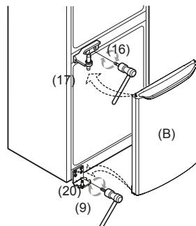
Приложите снятую нижнюю петлю (20) к отверстиям, расположенным на противоположной стороне корпуса и закрепите её болтами (21). Вкрутите болт (22) в корпус с противоположной стороны. Установите дверь морозильного отделения на ось нижней петли. Разверните снятую среднюю петлю (17) осью наружу и закрепите ее болтами (16) (затягивать болты следует аккуратно, чтобы не поцарапать дверь).
