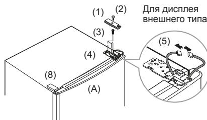
Снимите верхнюю крышку двери (7) (только для моделей с дисплеем внешнего типа), вытяните кабель (5) и установите его в отверстие на противоположной стороне двери. Установите верхнюю крышку двери (7) на место.
