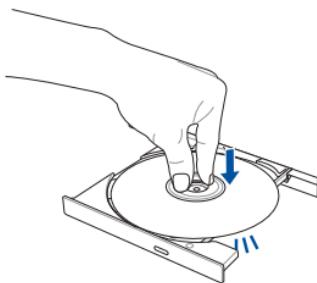
5. Осторожно задвиньте лоток привода на место.
