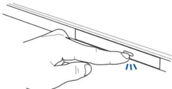
2. Осторожно потяните за переднюю панель привода и полностью выдвиньте лоток.
