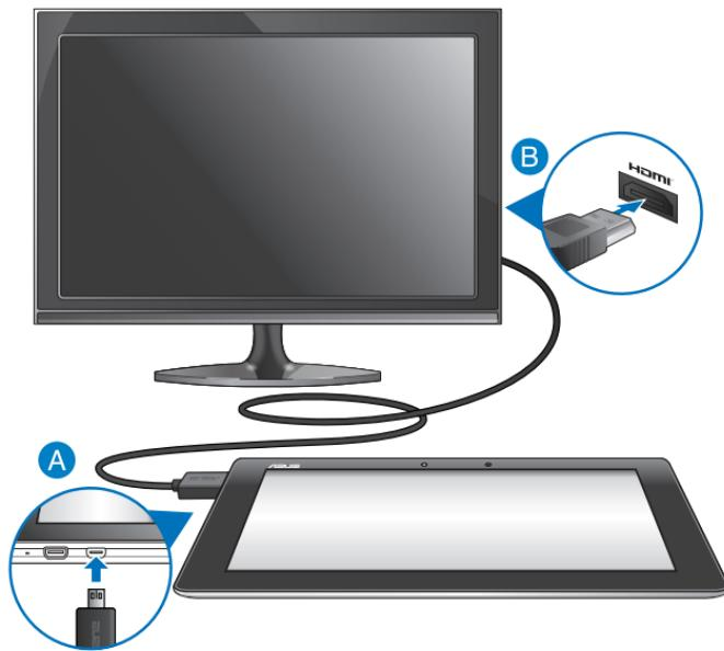
Для подключения внешнего HDMI-дисплея:
