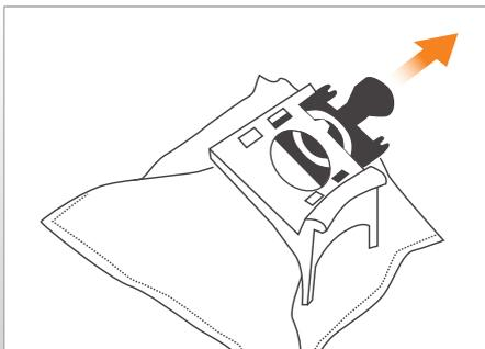
Извлечь пылесборник из держателя. Для этого потянуть пылесборник за цветную ручку. При этом преодолеть сопротивление стопора на держателе, слегка прижав вверх пластиковую поверхность пылесборника.
