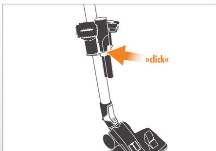
Для того, чтобы всегда иметь принадлежности пылесоса под рукой, можно для хранения вставить насадки в отдельный держатель Varioclip, который можно удобно закрепить на телескопической трубе, рукоятке или в парковочном устройстве, расположенном на задней стороне прибора.
