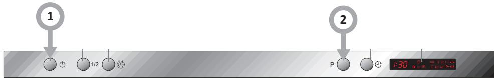
Открыть дверцу посудомоечной машины и включить устройство с помощью кнопки Standby (1)
