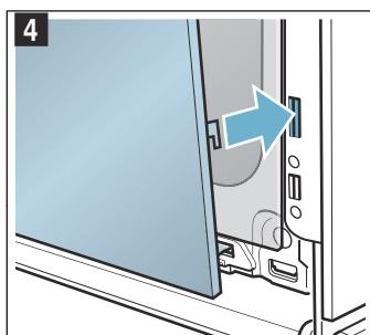
5. Нажмите на переднее стекло так, чтобы оно зафиксировалось со слышимым щелчком (рис. 5).
