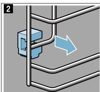
3. Затем поверните весь навесной элемент наружу **a** и выньте его заднюю часть **b** (рис. 3).
