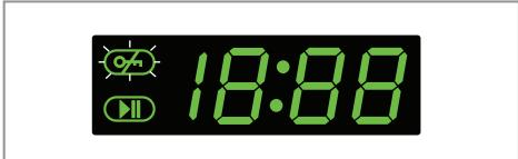
Если дверца стиральной машины заперта, на дисплее высвечивается значок (замок).
