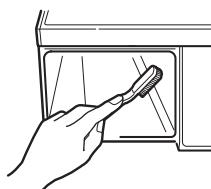
3. При помощи щетки очистите отсек для выдвижного ящика.
