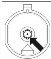
*Înlocuirea injectorului – injectorul trebuie de desșurubat cu ajutorul cheii de 7 și de schimbat cu altul nou, corespunzător tipului de gaz furnizat (vezi tabela).*
