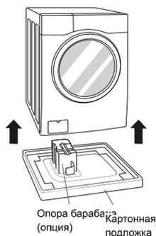
**2** Снимите болтовые соединения.
