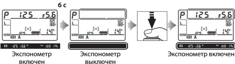
Время, по истечении которого экспонометр автоматически выключается, можно изменить при помощи пользовательской настройки с2 (**Задержка автовыкл. зам.**, □ 291).
