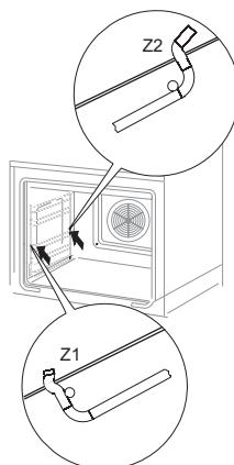
Духовки имеют нержавеющие выдвижные направляющие вкладышей, прикреплённые к проволочным направляющим. Направляющие следует вынимать и мыть вместе с проволочными направляющими. Перед размещением на них противней следует их высушить (если духовка горячая, направляющие следует высушить, зацепляя задний край постивня за упоры, находящиеся в передней части высушенных направляющих) и затем всунуть вместе с эмалированным противнем\*.
