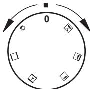
precum si butonul pentru reglarea temperaturii – pentru a seta o anumita functie trebuie sa rotiti butonul in pozitia selectata.
