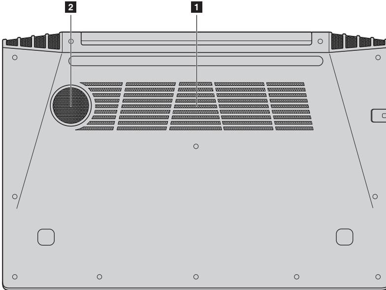
**1** **Вентиляционные отверстия** Обеспечивают подачу воздуха для охлаждения компьютера.
