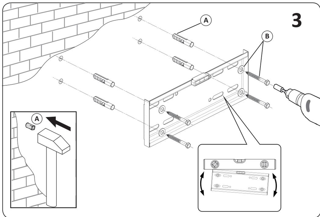
**Увага!** Після встановлення кронштейну перевірити надійність його кріплення до стіни.
