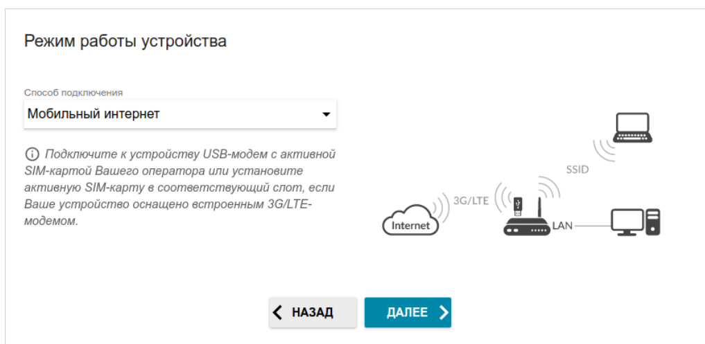
Рисунок 34. Выбор режима работы устройства. Режим Мобильный интернет .
