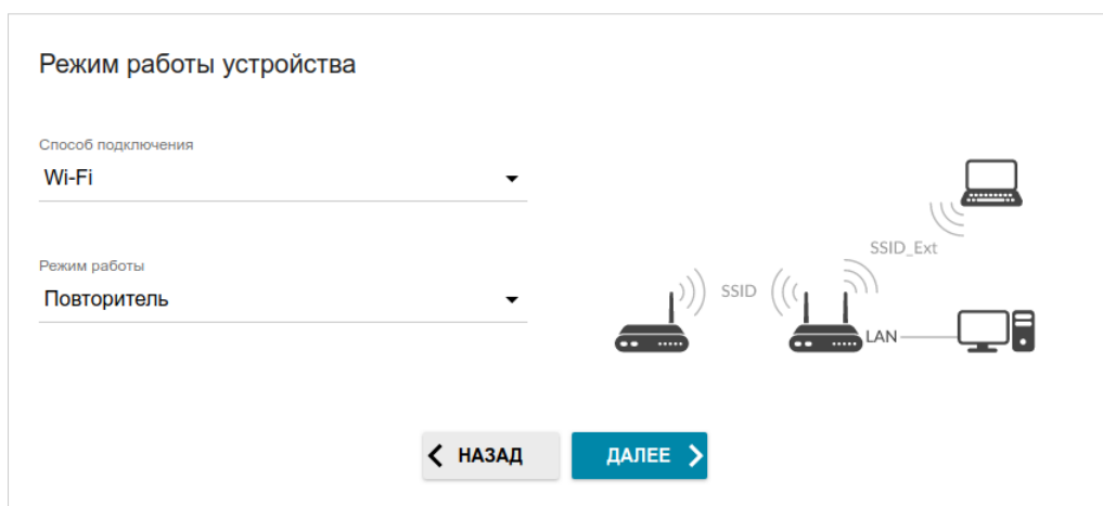
Рисунок 37. Выбор режима работы устройства. Режим Повторитель .
