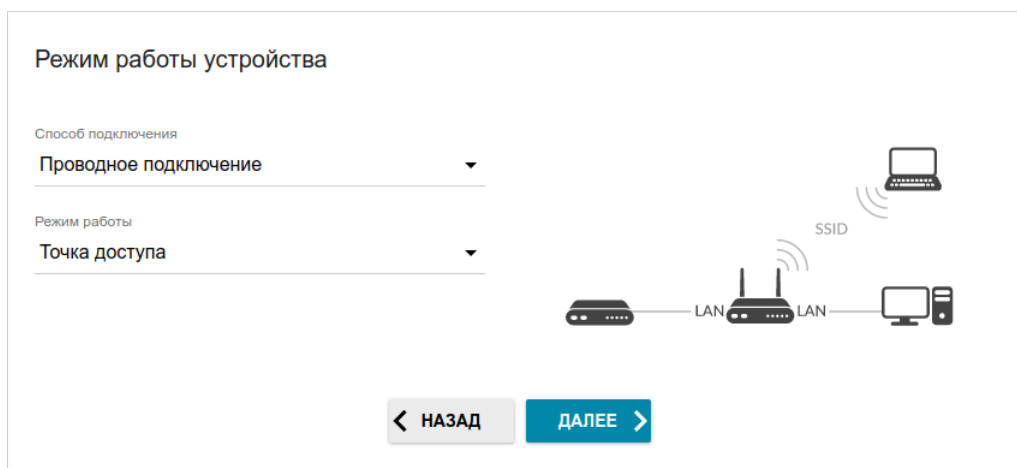
Рисунок 36. Выбор режима работы устройства. Режим Точка доступа .
