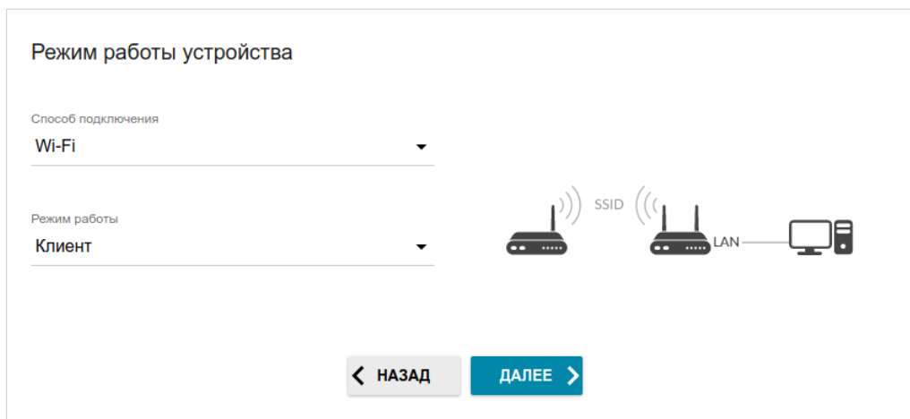
Рисунок 38. Выбор режима работы устройства. Режим Клиент.
