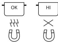
Слід застосовувати лише каструлі і сковороди, які виготовлено з феромагнітного матеріалу, що призначенні для використання з індукційними варильними панелями:
