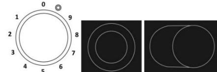
Активна зона двокільцевої конфорки може пристосуватися до розміру й форми посуду. Щоб задіяти більшу зону нагрівання, поверніть регулятор конфорки до упора (буде чутно кладання), далі встановіть потрібний рівень потужності.
