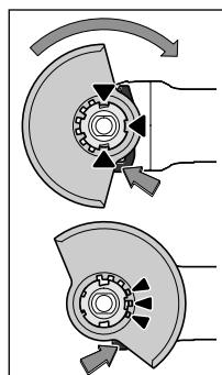
Stavite zaštitnu haubu **6** na prihvati na električnom alatu, da kodni ispusti zaštitne haube budu usaglašeni sa prihvatom. Pritisnite i držite pritom polugu za deblokadu **1**. Pritisakajte zaštitnu haubu **6** sve dok venac zaštitne haube ne nalegne na prirubnicu električnog alata i okrećite zaštitnu haubu sve dok jasno i da se čuje ne uskoči. Prilagodite poziciju zaštitne haube **6** potrebama rada.
