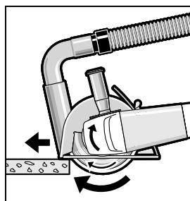
Uključite električni alat i stavite ga na izradak sa prednjim dijelom vodilice. Pomičite električni alat sa umjerenim posmakom prilagođenim obradivanim materijalu.
