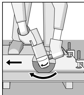
Električno orodje vedno premikajte protismerno. V nasprotnem primeru obstaja nevarnost, da bo **nekontrolirano** izpadlo iz reza.
