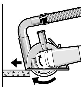
Uključite električni alat i stavite ga sa prednjim delom klizača vodice na radni komad. Gurajte električni alat sa umerenim pomeranjem napred koje je prilagođeno materijalu koji se obrađuje.
