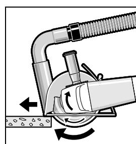
Включете електроинструмента и поставете предната част на направляващата шейна върху детайла. Придвижвате електроинструмента с умерено, съобразено с обработвания материал подаване.
