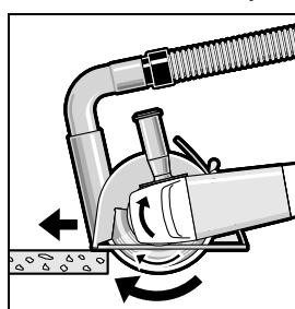
Elektronáradí zapněte a posadte jej předním dílem vodicích saní na obrubek. Elektronáradí posouvejte s mírným, opracovanému materiálu přizpůsobeným posuvem.
