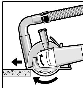
Porniți scula electrică și puneti-o cu partea anterioară a saniei de ghidare pe piesa de lucru. Împingeți scula electrică cu avans moderat, adaptat materialului de prelucrat.
