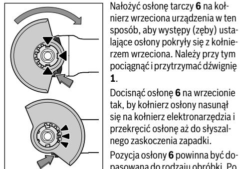
Nałożyć osłonę tarczy 6 na kołnierz wrzeciona urządzenia w ten sposób, aby występy (zęby) ustalające osłony pokryły się z kołnierzem wrzeciona. Należy przy tym pociągnąć i przytrzymać dźwignię 1.
