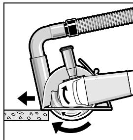
Vklopite električno orodje in ga s sprednjim delom drsnega vodila postavite na obdelovalec. Električno orodje pomikajte z zmernim pomikom, ki ga morate prilagoditi materialu, ki ga obdelujete.
