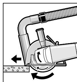
Zapnite ručné elektrické náradie a priložte ho prednou časťou vodiacich saní na obrobok. Miernym posuvom, ktorý zodpovedá obrábanému materiálu, prisúvajte náradie k obrobku.
