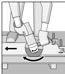
Električni alat mora se uvijek voditi protuhodno. Međutim postoji opasnost da se **nekontrolirano** istisne iz reza. Kod rezanja profila i četverokutnih cijevi najbolje je da stavite na najmanji presjek.
