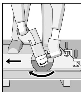
Az elektromos kéziszerszámot mindenkor forgással ellenkező irányba kell vezetni. Ellenkező esetben a készülék **irányithatatlanul** kiugorhat a vágásból.
