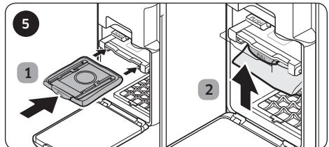
Задвиньте новый мешок для сбора пыли внутрь и с усилием нажмите снизу вверх на рычаг «PULL», чтобы он зафиксировался со щелчком.
