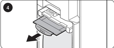
Вытяните рычаг «PULL» по диагонали и извлеките мешок для сбора пыли.
