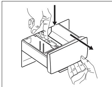
2. Зніміть верхню частину відділення для добавок, щоб полегшити процес очищення, та промийте її проточною теплою водою, щоб видалити залишки миючого засобу. Після очищення поверніть верхню частину на місце.
