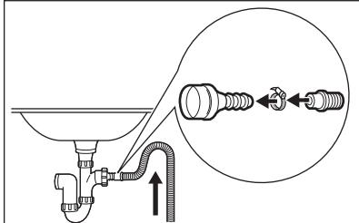
Переконайтесь в тому, що зливний шланг формує петлю для попередження потравляння часточок з раковини до приладу.
