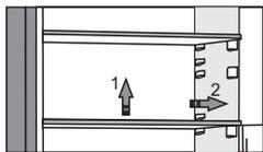
Полки внутри холодильного отделения можно переставлять на разную высоту, не извлекая из холодильника. Предварительно освободите полку от продуктов. Чтобы переставить или извлечь полку, слегка приподнимите ее сзади, потяните на себя и затем переставьте на другой уровень или извлеките. Храните скоропортящиеся продукты в задней части полки, где температура ниже.
