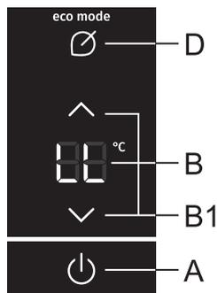
**Включение.** Одновременно нажмите и удерживайте (2 секунды) кнопки **A** и **D**, чтобы включить защитную блокировку. Раздастся звуковой сигнал, и на дисплее **B** загорится и погаснет индикация **LL**.
