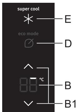
**Включение функции «Интенсивное охлаждение».** Чтобы включить функцию, нажмите кнопку **Е**. Раздастся звуковой сигнал, и загорится индикатор **super cool**.
