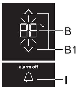
При отключении электроэнергии температура внутри прибора может превысить допустимый уровень. В этом случае после возобновления электроснабжения включится сигнализация о превышении допустимой температуры. Раздастся звуковой сигнал, и на дисплее **В** или **С** начнет мигать индикация «**PF**» в зависимости от того, в каком отделении прибора зафиксировано повышение температуры.
