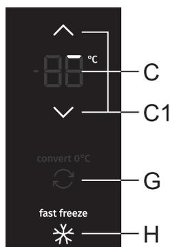
**Включение функции «Быстрое замораживание».** Чтобы включить функцию, нажмите кнопку **Н**. Раздастся звуковой сигнал, и загорится индикатор **fast freeze**.
