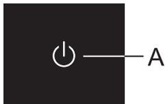
**Включение прибора.** Чтобы включить прибор, нажмите кнопку **A**. Раздастся звуковой сигнал, и на дисплеях **B** и **C** отобразится температура.
