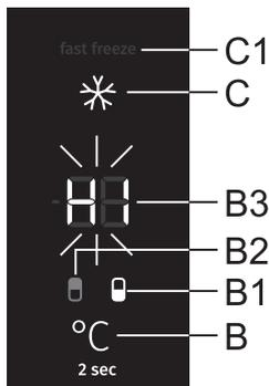
В случае значительного повышения температуры в приборе включается прерывистый звуковой сигнал. На дисплее **В** или **С** начинает мигать индикация «HI», и загорается индикатор отделения, в котором превышена температура.
