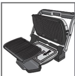
3. Åpne grillen, fjern stekeplatene og bytt dem med vaffelplatene. Monter den nederste platen først, og deretter den øvre platen.
