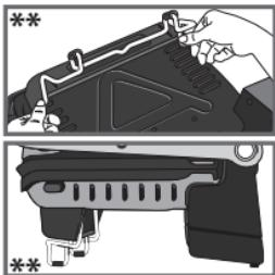
2. Vend apparatet om, og sæt det udtrækkelige stativ på, så apparatet er plan. På denne måde løber dejen ikke over kanten, når den hældes på pladerne.
