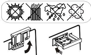
2. Подключите батарею: потяните ее за ручку вверх, а затем протолкните в устройство.
