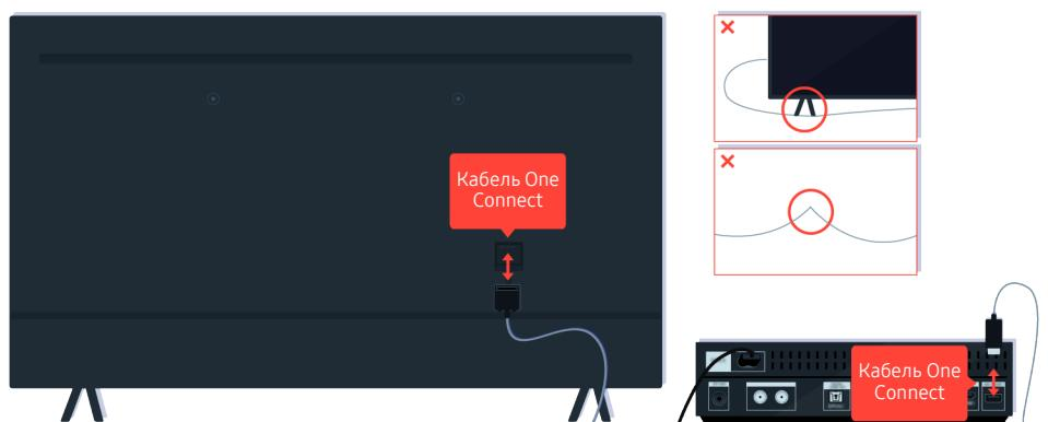
Від'єднайте та знову під'єднайте кабель One Connect, яким телевізор підключено до приставки One Connect (OC). Перевірте, чи кабель One Connect не притиснутий і не має різких згинів.
