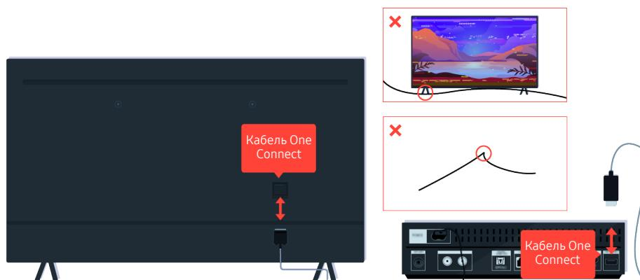
Якщо усунути проблему не вдається й для телевізора використовується Кабель One Connect, від'єднайте та знову під'єднайте кабель Кабель One Connect до телевізора та приставки One Connect (OC). Перевірте, чи кабель Кабель One Connect не притиснутий і не має різких згинів.
