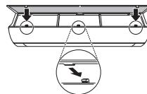
**8** Проверьте сторону передней крышки на правильность сборки воздушного фильтра.
