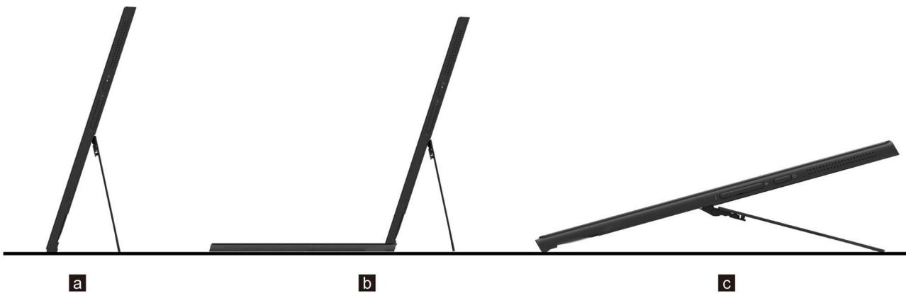
Подставка является многопозиционной. Положение подставки можно изменять, устанавливая ее под разными углами для повышения удобства работы.
